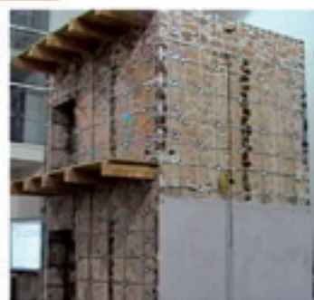
CON UTILIZZO SISTEMA CAM Accelerazione limite strumentale PGA = 1,20 G fessurazioni localizzate Riserve plastiche totalmente disponibili
